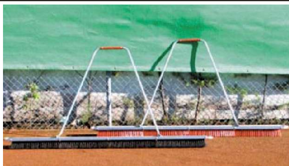
Tennisplatzbesen TOP 200 cm breit, zur Pflege des Spielfeldes direkt nach dem Spiel, bestehend aus 4 Besenteilen à 50 cm Länge, welche in einen ALU-U-Schienerahmen geschoben werden, kpl. mit Bügel, seitliche Abweiser verhindern ein hängenbleiben im Netz oder Zaun
