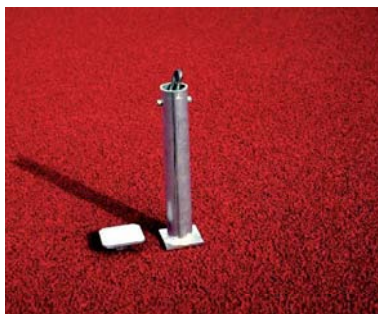
Erdanker-Versenkchülse zum Erreichen der vorgeschriebenen Netzhöhe in der Feldmitte, Länge: 250 mm mit versenkbarer Oese und Abdeckkappe, Oberfläche: Alu-naturblank
